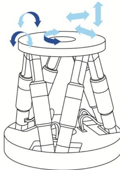
Abb. 2 Prinzipaufbau: Bei parallelkinematischen Systemen wirken alle Aktoren unmittelbar auf die gleiche Plattform (Foto: PI)
