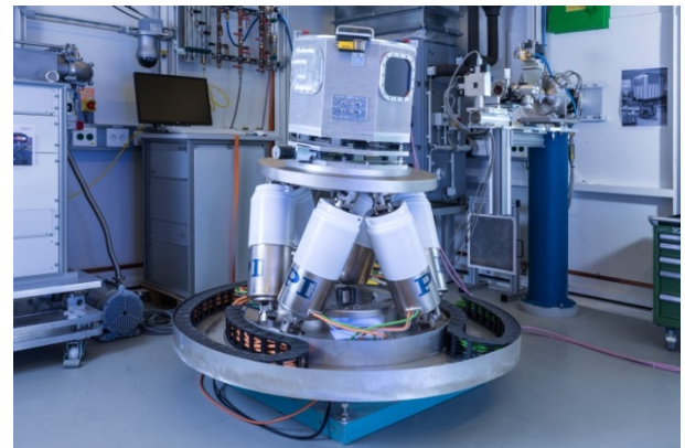
Abb. 7 Hexapod in der Experimentierhütte EH3 der Strahlführung P07 an PETRA III: Durch seine große Tragfähigkeit kann er den vollständigen Messaufbau tragen mitsamt der Vorrichtung zum Aufbringen mechanischen oder prozesstechnischen Beanspruchung – im Bild eine Kammer zum Laserschweißen von Titanaluminiden (Bild: PI/Helmholtz-Zentrum Geestach)
